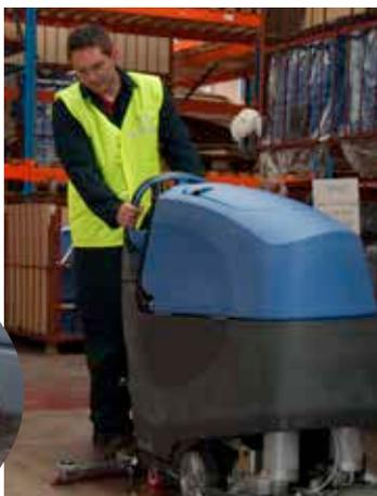
Per l'azionamento, portare la chiave di accensione on/off in posizione "ON", selezionare la portata dell'acqua, la miscela di prodotti chimici (vedere pag. 15), abbassare il tergilavaggio (vedere pag. 14) e selezionare la marcia in avanti (vedere pag. 9, Fig. 4), quindi premere il comando start / stop.
