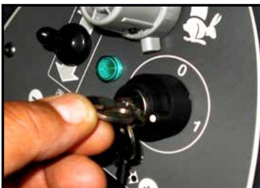
Inserire la chiave nell'accensione (comando on/off) e ruotarla di un quarto di giro in senso orario portandola nella posizione "ON".
