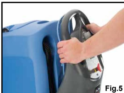
Premere la maniglia di comando con entrambe le mani e portare lentamente la macchina fuori dalla pedana (Fig. 5); il quadro comandi è dotato di un dispositivo di controllo della velocità variabile.
