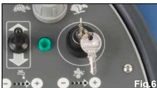
Dopo che la macchina è stata rimossa e sistemata in posizione sicura, riportare la chiave in posizione "OFF" (Fig. 6).
