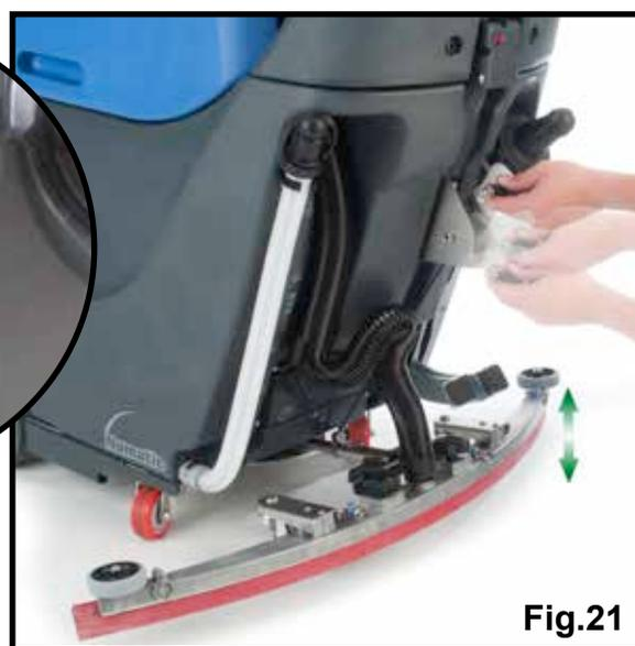
Dopo aver preparato il pavimento (vedere la sezione precedente), impostare i comandi in funzione delle condizioni di pulizia. Prima di applicare le impostazioni, verificare che il gruppo spazzole sia stato abbassato (Fig. 23). Azionare la leva del tergipavimento (Fig. 20), portandola in posizione abbassata (Fig. 21).
