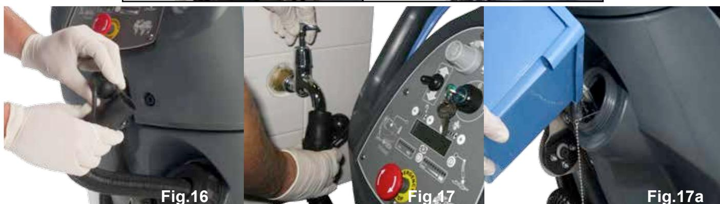
Per riempire il serbatoio acqua pulita, estendere il tubo flessibile situato sul retro della macchina al centro del bocchettone di rifornimento amovibile (Fig. 14). Estrarre il tubo flessibile (Fig. 15). Aprire la chiusura (Fig. 16) e sistemare il tubo flessibile sotto il rubinetto dell'acqua o utilizzare un tubo flessibile per iniziare il rifornimento, (Fig. 17).
