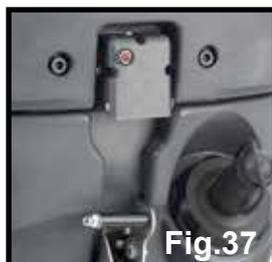
La presa di ricarica è situata sul lato posteriore della macchina sotto il quadro comandi. (Fig. 37)
