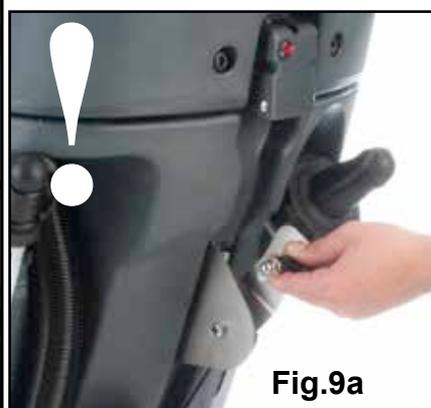
Abbassare il braccio tergipavimento portando la leva di sblocco nella posizione superiore (Fig. 7).
