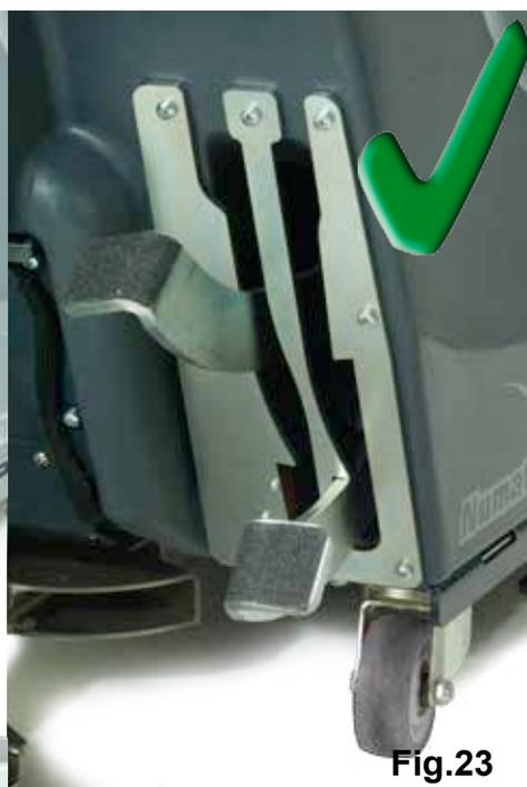
Il comando per l'abbassamento del gruppo spazzole è situato sul lato posteriore destro della macchina (Fig. 22). Abbassare il gruppo spazzole portando la leva di sblocco di sinistra nella posizione superiore (Fig. 23).
