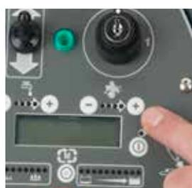
Impostare la Miscela detergente chimico richiesta, a seconda del tipo di pavimento e del livello di sporcizia.
