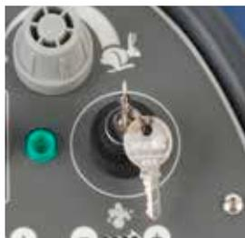
Inserire la chiave nell'accensione (comando on/off) e ruotarla di un quarto di giro in senso orario portandola nella posizione "ON".
