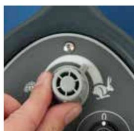
Impostare la velocità spazzole richiesta, a seconda del tipo di pavimento e del livello di sporcizia.
