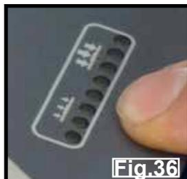
Lo strumento di misura indica il livello di carica delle batterie. Quando completamente cariche, tutte le spie sono illuminate (vedere la Fig. 36).
