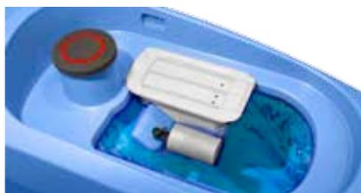
Nel serbatoio acqua sporca (superiore) è situato un interruttore serbatoio pieno che ferma la macchina quando l'acqua sporca raggiunge il limite massimo. A volte l'interruttore si intasa o si ostruisce, mantenerlo pulito per garantirne il corretto funzionamento (pagina 15)
