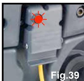
Quando l'alimentazione da rete viene collegata, l'indicatore di ricarica rosso si illumina. Per garantire la ricarica completa, la macchina deve rimanere sotto carica per un periodo di 8 - 12 ore. A ricarica completata, scollegare il cavo di ricarica dalla presa di alimentazione e dalla macchina
