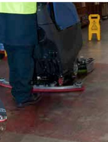
In presenza di striature, pulire le lame del tergipavimento (Fig. 29). Su pavimenti molto sporchi, utilizzare la tecnica della "doppia pulitura". Effettuare prima una pulitura preliminare del pavimento con il tergipavimento rialzato, lasciando al detergente chimico il tempo di agire e poi ripassare l'area una seconda volta con il tergipavimento abbassato.
