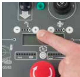
Impostare il Flusso acqua richiesto, a seconda del tipo di pavimento e del livello di sporcizia.
