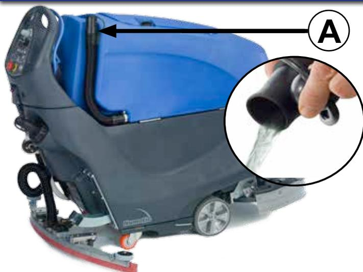
Dopo l'uso, svuotare il serbatoio dell'acqua sporca utilizzando il flessibile di drenaggio e risciacquare con acqua pulita. **(A)**
