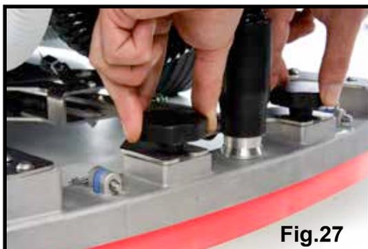
Per fissare la lama al supporto, allentare prima le manopole di ritegno sulla struttura del tergipavimento e farla scorrere sulla staffa di supporto.
