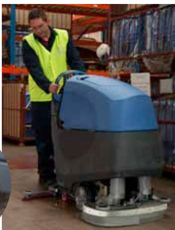
Per l'azionamento, portare la chiave di accensione on/off in posizione "On", selezionare la portata dell'acqua, la miscela di prodotti chimici (vedere pag. 14), abbassare il tergipavimento (vedere pag. 13) e selezionare la marcia in avanti (vedere pag. 8, Fig. 4), quindi premere il comando start / stop.
